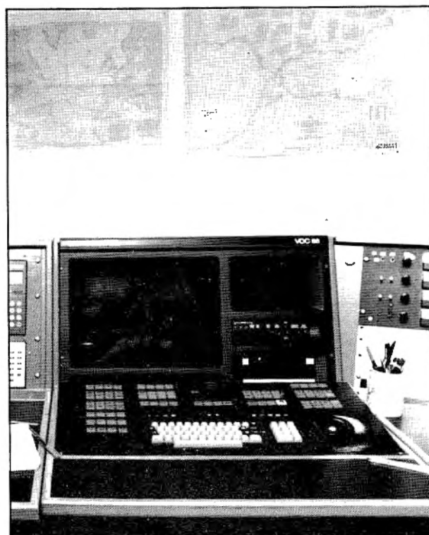
Consolas desde donde se sigue el tráfico marítimo por el Estrecho. (Foto M. Rojas).
