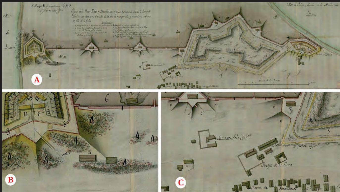
16.- Estado de las obras el 15 de septiembre de 1732 A) Glacis prácticamente terminados, banqueta completa con sus gradas concluidas y las plazas de armas con sus cuerpos de guardia techados. B) Detalle de Santa Bárbara y acopio de material. C) Detalle de la zona del Principal, con pabellón de ingenieros, almacenes de pertrechos y asentistas, con chozas de trabajadores y vivanderos, antecedentes de actual ciudad. AGS. MPD 23,009
