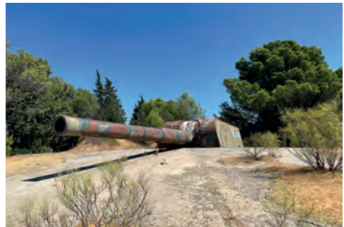
Una de las grandes piezas de artillería de costa Vickers 38.1/45 emplazadas en Punta Paloma (Tarifa) en el flanco oeste del sistema de artillado del Estrecho
