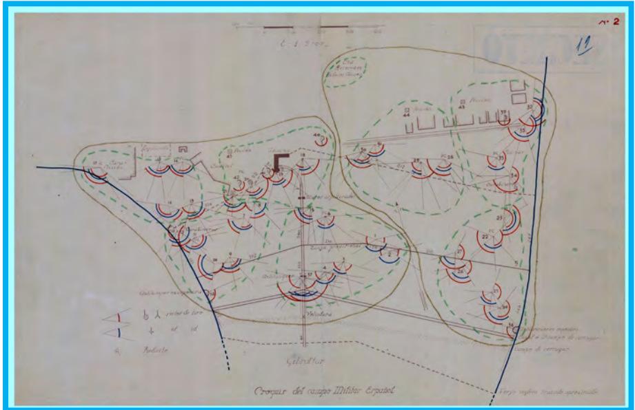
Croquis del campo militar español, con posiciones fortificadas, sus sectores de tiro, zanja antitanque, muros aspillados, “caponeras” o casamatas y “verrugas” o dientes de dragón. Archivo General Militar de Ávila. IHCM. Archivo Guerra de Liberación. Legajo 474, Carpeta 27, Armario 10, Doctº nº 19
