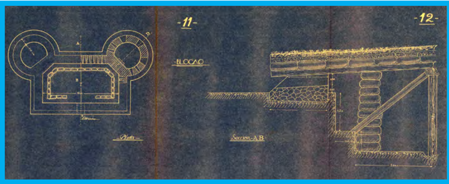
Blocao de inspiración colonial, obra de campaña propia de la guerra de Marruecos diseñada para el frente del norte en la Guerra Civil (1937). Archivo General Militar de Ávila. IHCM. Archivo Guerra de Liberación. Legajo 474. Batallón de Ingenieros de la 1ª División. Fig. 11 y 12. Reinosa, 1937
