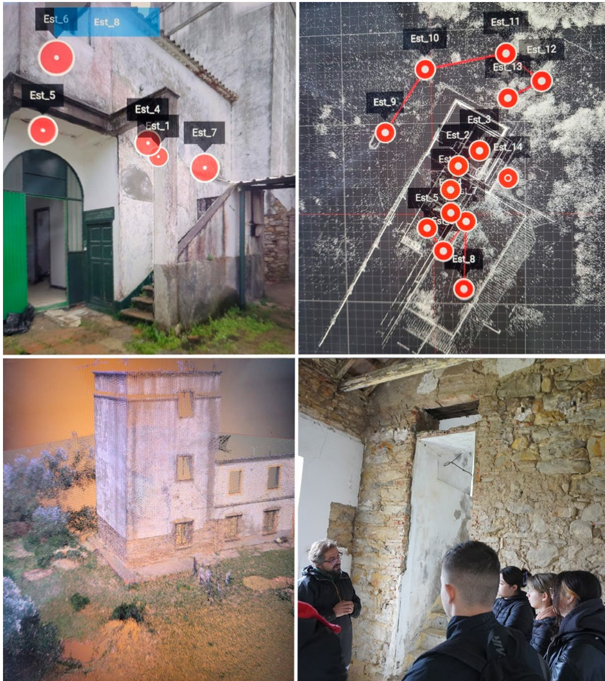
Lámina 2: Clase práctica sobre el procesado y digitalización de estructuras, mediante escáner láser 3D Leica RTC360 . Imágenes de los autores
