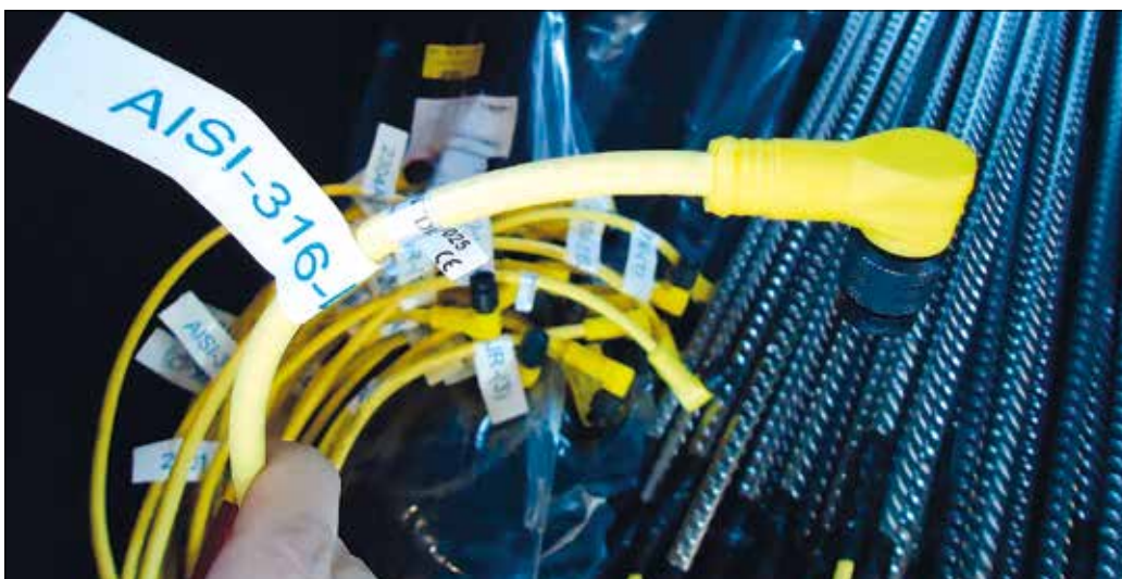
Lámina 3. Cable resistente al agua de mar. Imagen de los autores
