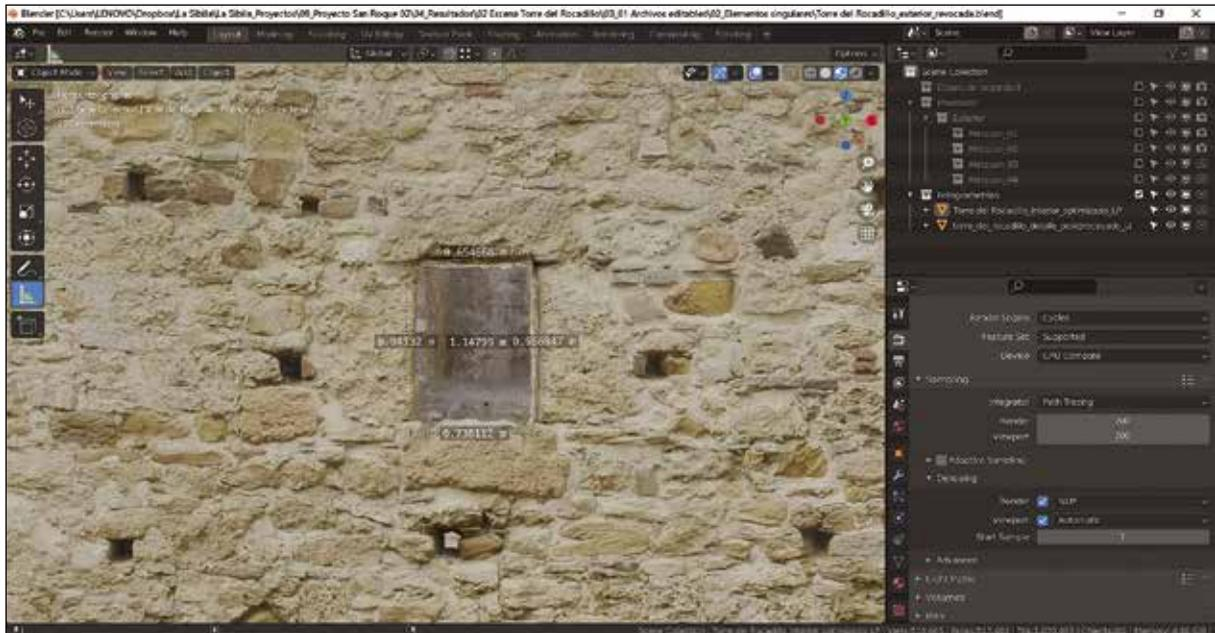
Lámina 18. Toma de medidas de la ventana-puerta de la torre del Rocadillo en el entorno del software Blender. Imagen de La Sibila S.L.
