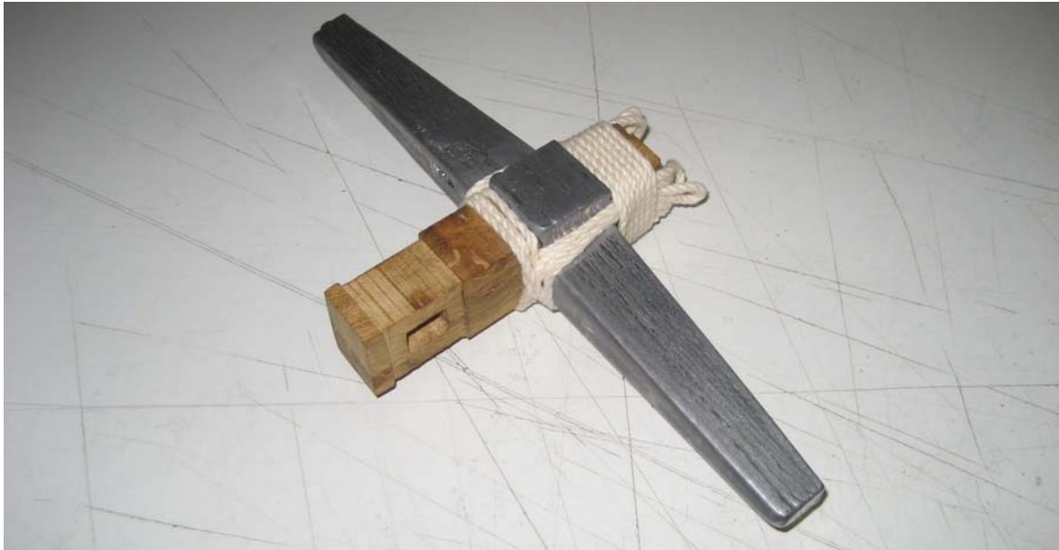
Figura 15.- Prueba de varias formas de hacer el firme para la entalingadura del ancla.
