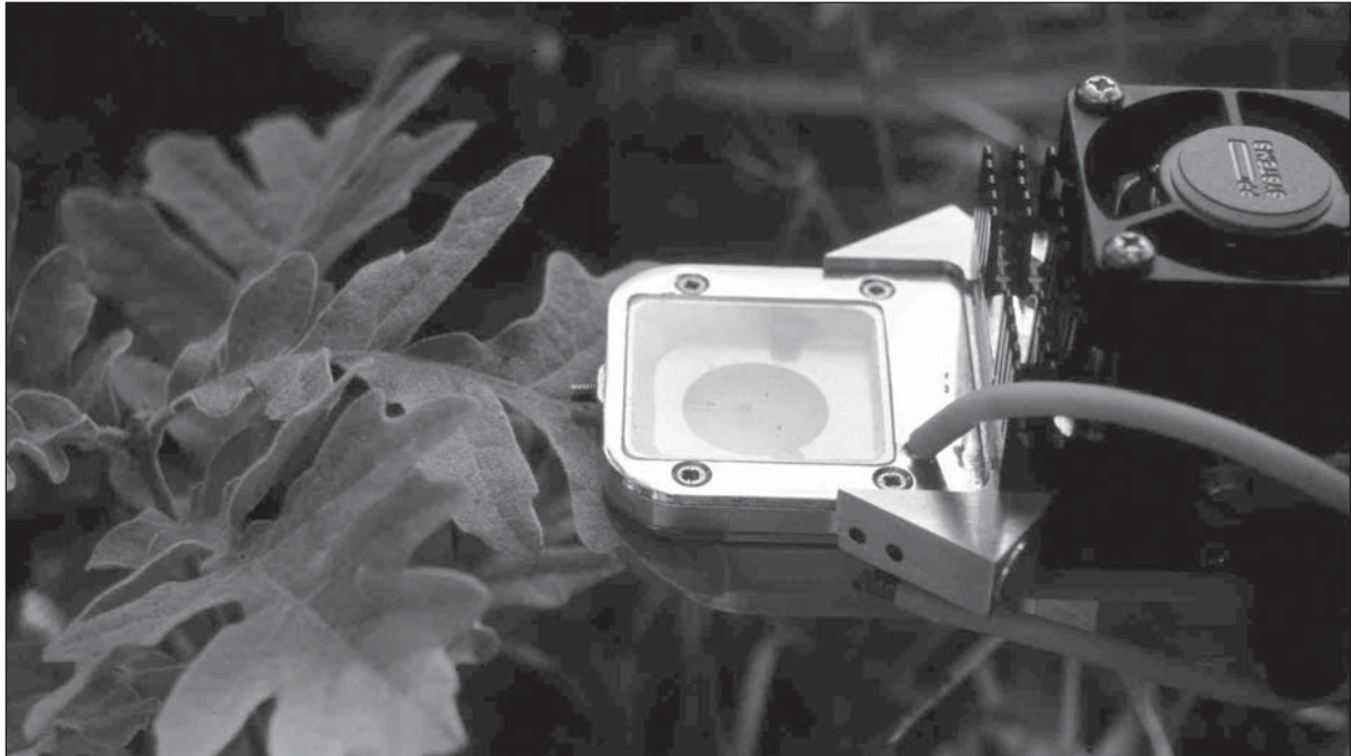
Figura 2. Detalle de la cámara del IRGA (siglas en inglés de "infrared gas analyzer") donde se introduce la hoja para detectar el intercambio gaseoso de \text{CO}_2 y \text{H}_2\text{O} (Foto, T. Marañón).
