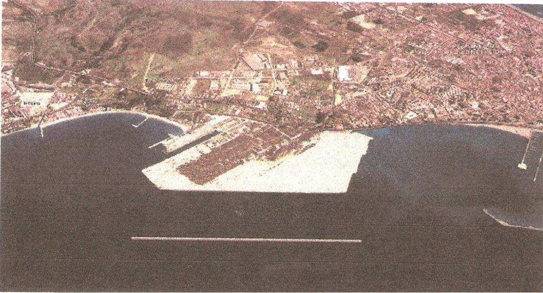
Composición virtual de los rellenos y escollera exenta (APBA: Portada de “Estudio Impacto Ambiental”)
